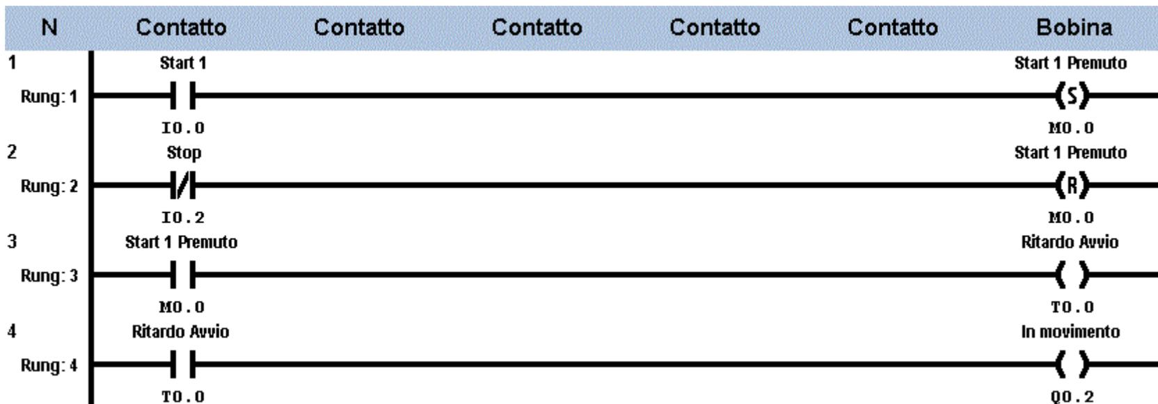
3. Con riferimento all'esempio "Tipo F: lampeggiante sincrono", utilizzare la memoria merker per consentire il rilascio di "Start 1" e il pulsante di "Start 2" per disattivare il temporizzatore.
