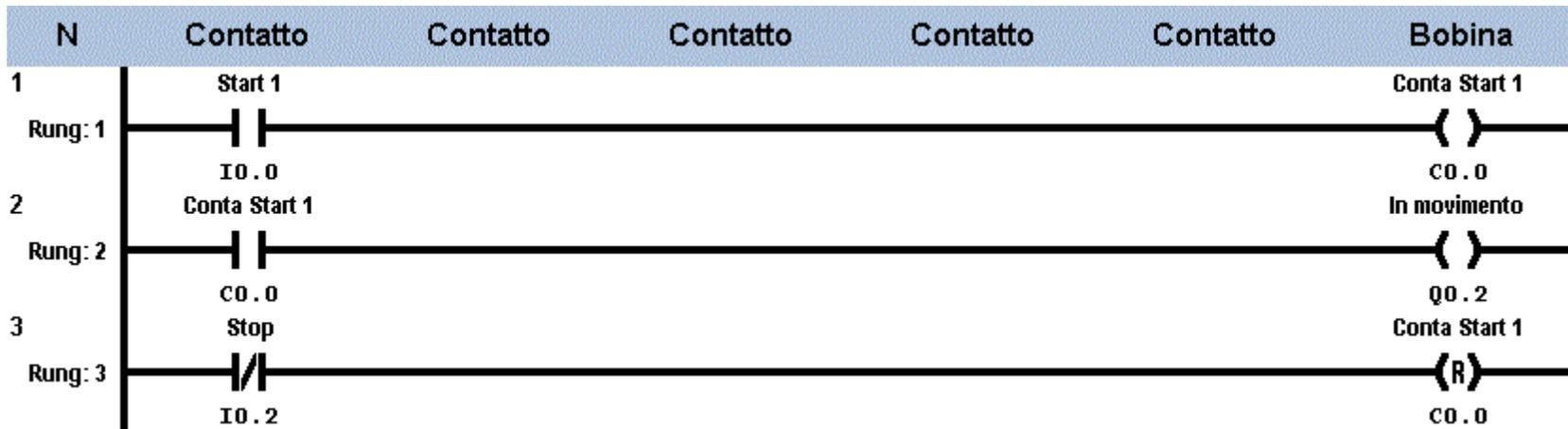
**Esempio 2 con il modulo “Pulsanti e Lampade”:** accensione della lampada “In movimento” dopo tre pressioni del pulsante “Start 1”, la pressione di “Start 2” decrementa il conteggio.
